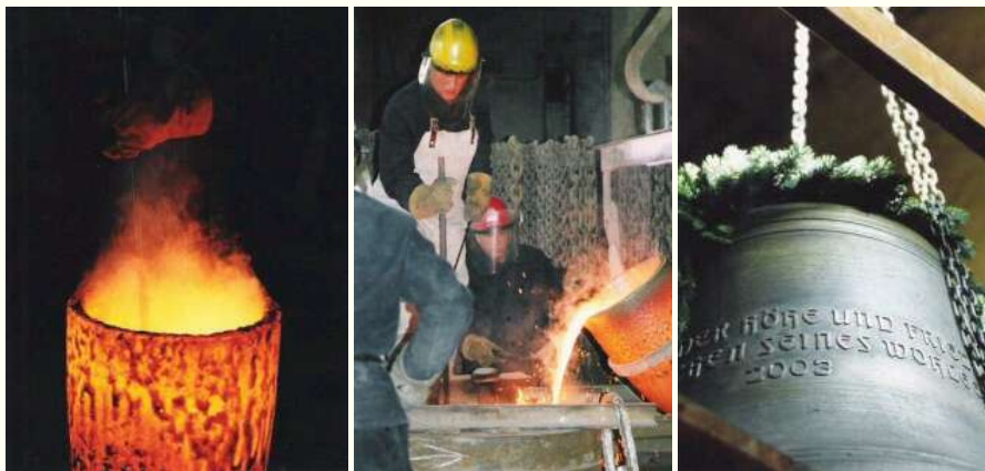
21. November 2003: In der Kunstgießerei in Lauchhammer wird aus glühender Glockenbronze die neue Glocke für die Kirche in Weißnig gegossen. Fotos: M. Weiß
